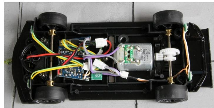
Inliner Chassis mit E200 Aggregat und vier Radlager aus Messing für Langlebigkeit und guten Rundlauf. Vom Digitalchip aus verzweigen sich die Zündkabel zu Motor und L-Kiel und der Kabelbaum für die Beleuchtung vorne und hinten. Wer das Aggregat und/oder die beiden Magneten ausbauen möchte, kann den Motor aus der Halterung klipsen und mit praktischen Schnell-Steckverbindungen alles voneinander trennen und wieder zusammenbauen. Dafür ist es sehr praktisch, dass die Kabel etwas länger sind.
